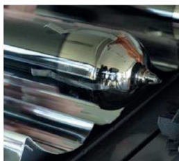
газопоглинач у порядку, трубка справна
