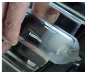
газопоглинач зруйнований, трубка несправна
