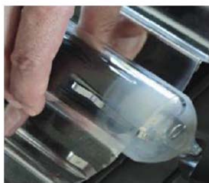
газопоглотитель разрушен, трубка неисправная
