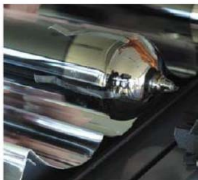
газопоглотитель в порядке, трубка исправная
