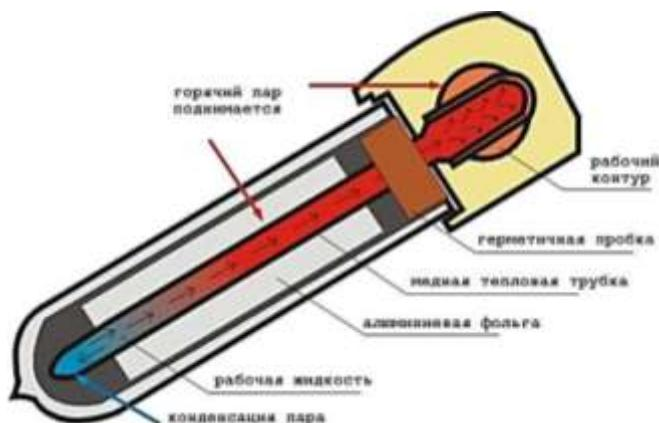
Конденсатор стержня подсоединяется к теплообменнику коллектора. Тепло накопленное в конденсаторе теплопроводящего стержня передаётся жидкости-теплоносителю (антифриз или вода) и пар переходит в жидкость, возвращаясь к нижней части (основанию) теплопроводящего стержня. Подобная передача тепла жидкости обеспечивает непрерывную циркуляцию по мере того, как гелиоколлектор нагревается лучами солнца.
