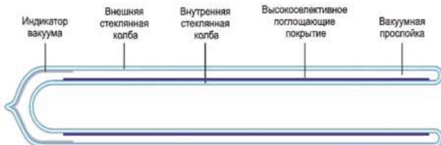
Продольный разрез коаксиальной вакуумной трубы
