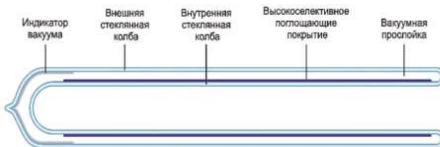
Продольный разрез коаксиальной вакуумной трубки
