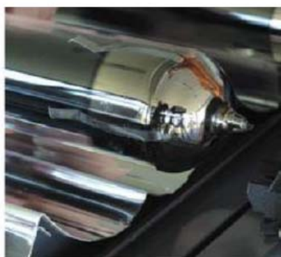
газопоглотитель в порядке, трубка исправная
