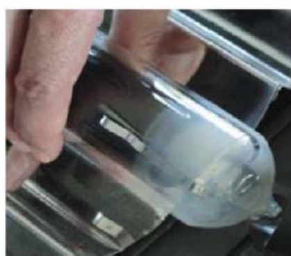
газопоглотитель разрушен, трубка неисправная
