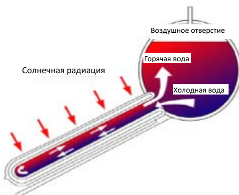
Принцип работы солнечного водонагревателя
