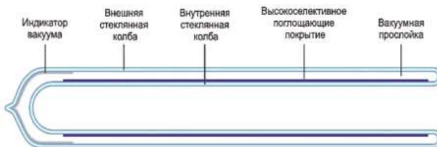
Продольный разрез коаксиальной вакуумной трубки
