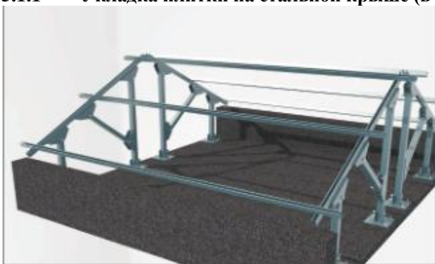
5-2-2.1 Стальная конструкция, монтаж стальных кровельных конструкций плоско-наклонных
