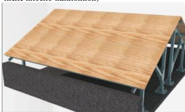
5-2-2.2 Стальная конструкция, ровный слой плоско-наклонной крыши (монтаж структурного слоя)
