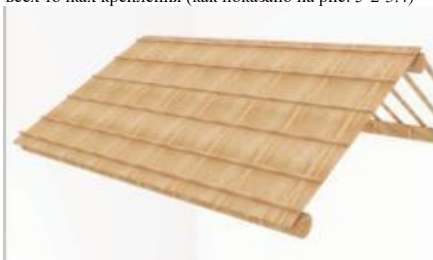
5-2-5.3 Установка деревянных реек
